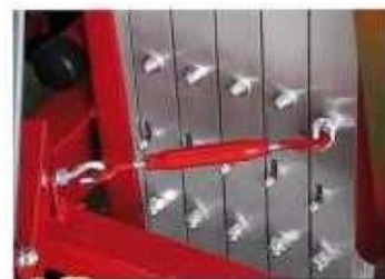
Tensor de bloqueo para el transporte
